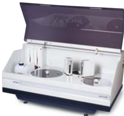
AP 300 DISCRETE: Analizador automático de iões para análise ambiental, complementado por reagentes prontos a usar, de alta qualidade
