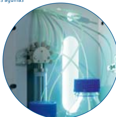
Alta energia – Digestão por UV a 187 e 254 nm
