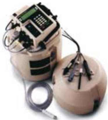
Amostrador automático portátil SIGMA 900 MAX
