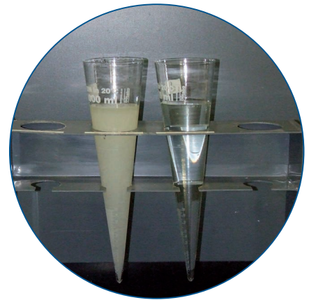
Fig. 5: Comparação clara – amostras de águas residuais no início e final do tratamento
